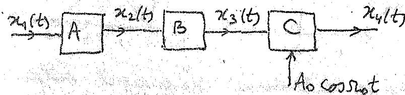
Blocul A reprezintă un sistem nelinear caracterizat prin relația intrare-iesire  $x_2(t) = ax_1(t) + bx_1^2(t)$ , cu  $a, b \in \mathbb{R}_+$ , blocul B este un sistem analogic liniar și invariant în timp, având funcție de pondere  $h(t) = \frac{\sin 3\omega_0 t}{\pi} \cdot \cos 10\omega_0 t$ , iar blocul C este un modulator de fază de bandă largă cu frecvență portătoare  $F_0 = 100 f_1$  ( $\max|k_p x_3(t)| < \frac{\pi}{2}$ ).
