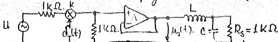
unde tensiunea  $U$  este sinusoidală cu frecvență de  $2\text{kHz}$ ,  $T = 100\mu\text{s}$ , iar amplificatorul este a.o.ideal.
