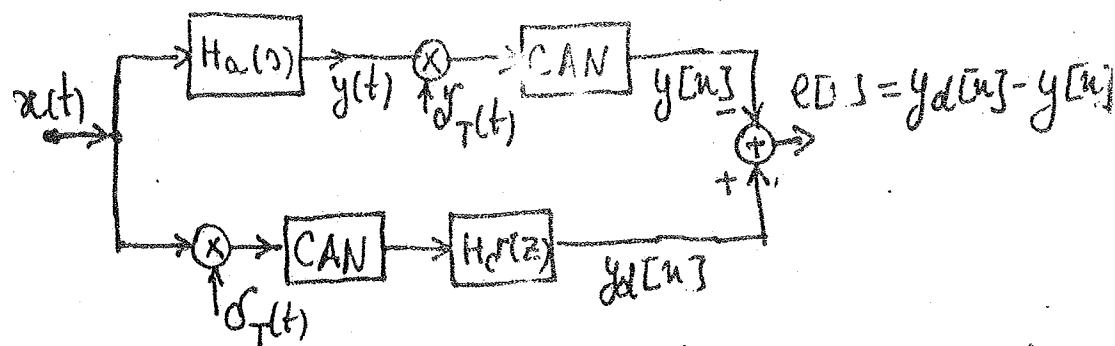
1. Considerând că funcția  $f_T(t)$  a sistemului simulat este precizată, stabilită și modalitate de determinare a funcției  $H_d(z)$  pentru sistemul numeric echivalent, astfel încât pentru un semnal  $x(t)$  de exemplu la precipitație, eroarea  $e[n]$  să fie nula (sistemul să fie invariант la acel semnal). Pentru cazul în care  $x(t) = f(t)$  (funcția trunchiată unitate) și  $H_a(s)$  cunoscut, arătați că
